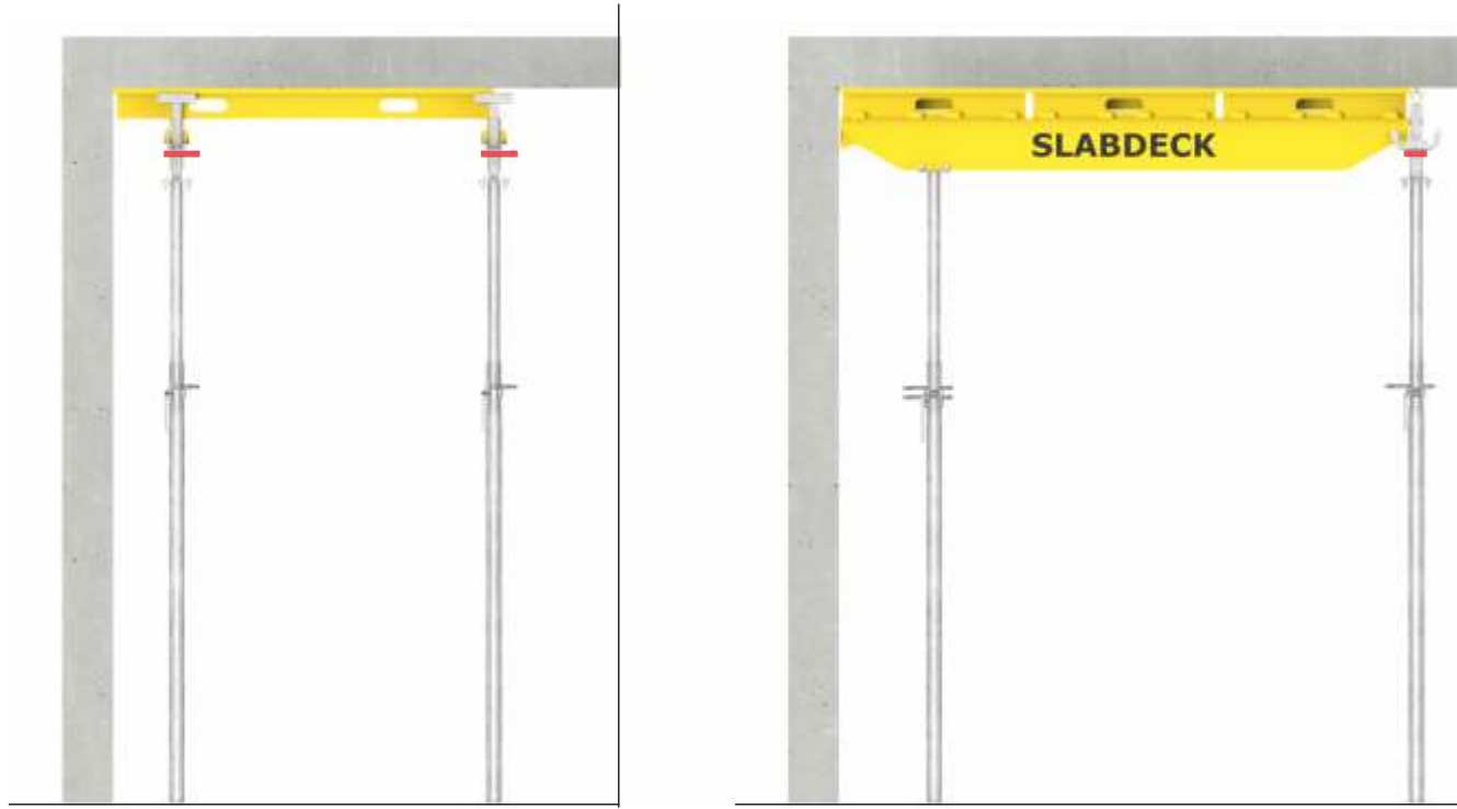
Slabdeck kirişe paralel doğrultuda kurulum başlangıcı. Parallel Direction Slabdeck Beam Assembly Startup
